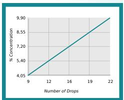
% Concentration = No. of Drops x Titration Factor Titration Factor = 0,45
