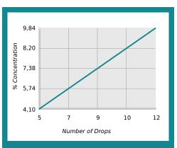
% Concentration = No. of Drops x Titration Factor Titration Factor = 0,82
