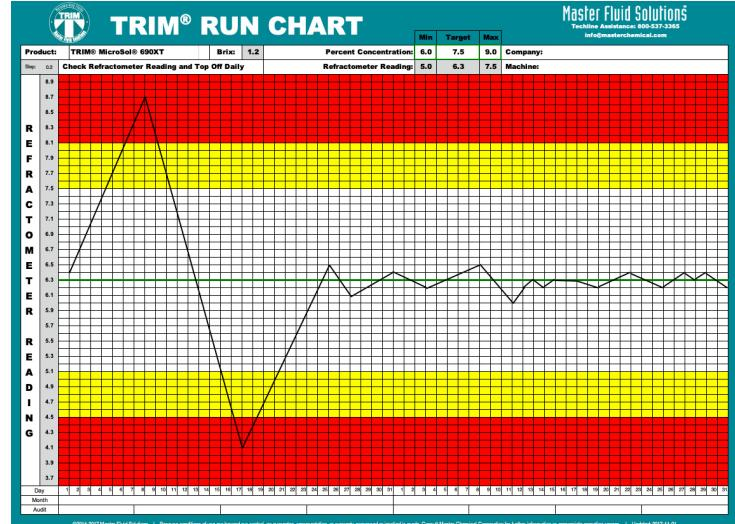
*El control de la concentración de refrigerantes tiene un efecto directo en el éxito de los programas de manejo de refrigerantes. Cada fluido soluble en agua está diseñado para funcionar dentro de un rango de concentración específica. Los fluidos que funcionan por debajo de ese rango a menudo tienen problemas de corrosión, herramiental y vida útil del colector. Funcionar por encima del rango a menudo muestran dermatitis, residuos y problemas de fluido excesivo.*
