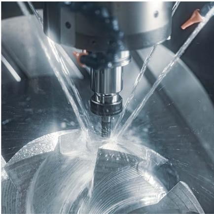
말레이시아에 본사를 두고 전 세계 30여 OEM 고객에게 제품을 공급하는 한 정밀 부품 제조업체는 수익률에 영향을 미치는 고가의 타사 냉각제를 사용해야 하는 문제에 직면했습니다. 해결책을 모색하던 이 회사는 Master Fluid Solutions<sup>®</sup>에 도움을 청했고, 합성 금속 가공액인 TRIM<sup>®</sup> C350을 시험적으로 사용해 보라는 권고를 받았습니다. 그 결과 총 비용이 15% 감소했고, 표면 마감은 개선되었으며, 과도한 거품 문제 해결로 운영 효율이 향상됨에 따라 수익성과 경쟁력이 높아졌습니다.
